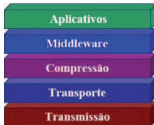
Figura 4 - Arquitetura de um sistema de TV Digital [Adaptado de Becker e Montez, 2004]
